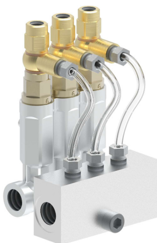
VOE10/C 0,1 - 0,2 - 0,4 - 0,6 cm 3 /stroke G1/4 air inlet M12x1 oil inlet M8x1 air-oil outlets
